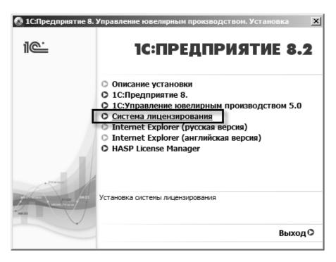
Если по каким-либо причинам программа установки СЛК не запускается, следует выполнить запуск программы установки вручную (программа setup.exe в каталоге configs\protection настоящего компакт-диска).
